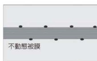
鉄筋は不動態被膜に保護されて錆びない。コンクリート中の水酸化カルシウム( $\text{Ca}(\text{OH})_2$ )が二酸化炭素と反応して、酸化カルシウムとなりPHが低下していく。
