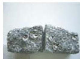
ヘリテージを凝灰岩に塗布浸透後、上図のように割列させるが、内部は吸水してしまう。ヘリテージは空気中の炭酸ガスや水分に触れた断面は、時間と共に防水を始め7~20日後には全体に及ぶ。これは反応性触媒が加水分解し疎水基が増殖するからです。建築現場で耐火ボードなどで撥水プレコートした建材を、切り取り加工した場合でも竣工までに断面は防水されます。施工後割れてしまった部分も一定時間後(7~20日)にはその亀裂面も防水ます。
